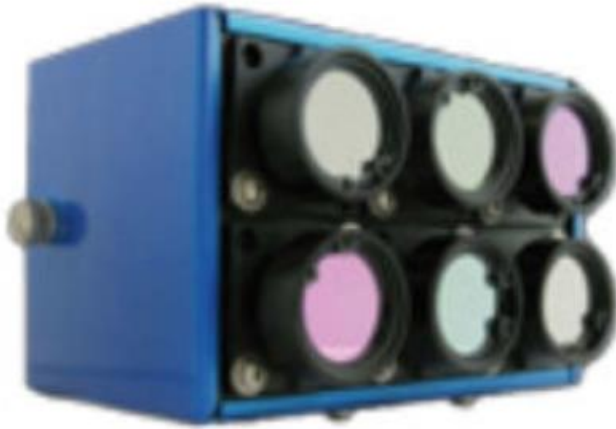
Figure 4.5: Tetracam Mini MCA-6
