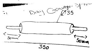
Drag conveyor sprocket shaft
