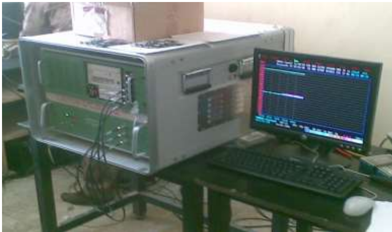
Fig. 1.1a : The Digisonde portable sounder (DPS).
